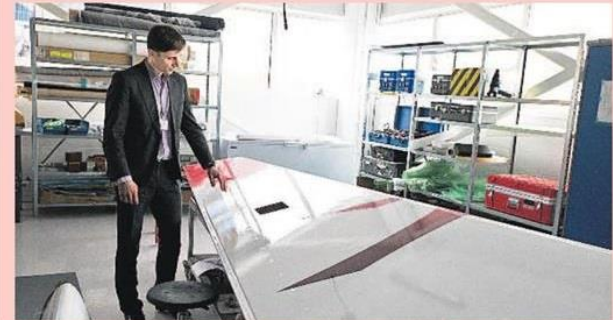
Lennukitib, mis koosneb tänapäeval eeskätt komposiitmaterjalist ja karbonkiust. Uuematel lennukitel alumiiniumi enam ei olegi.
