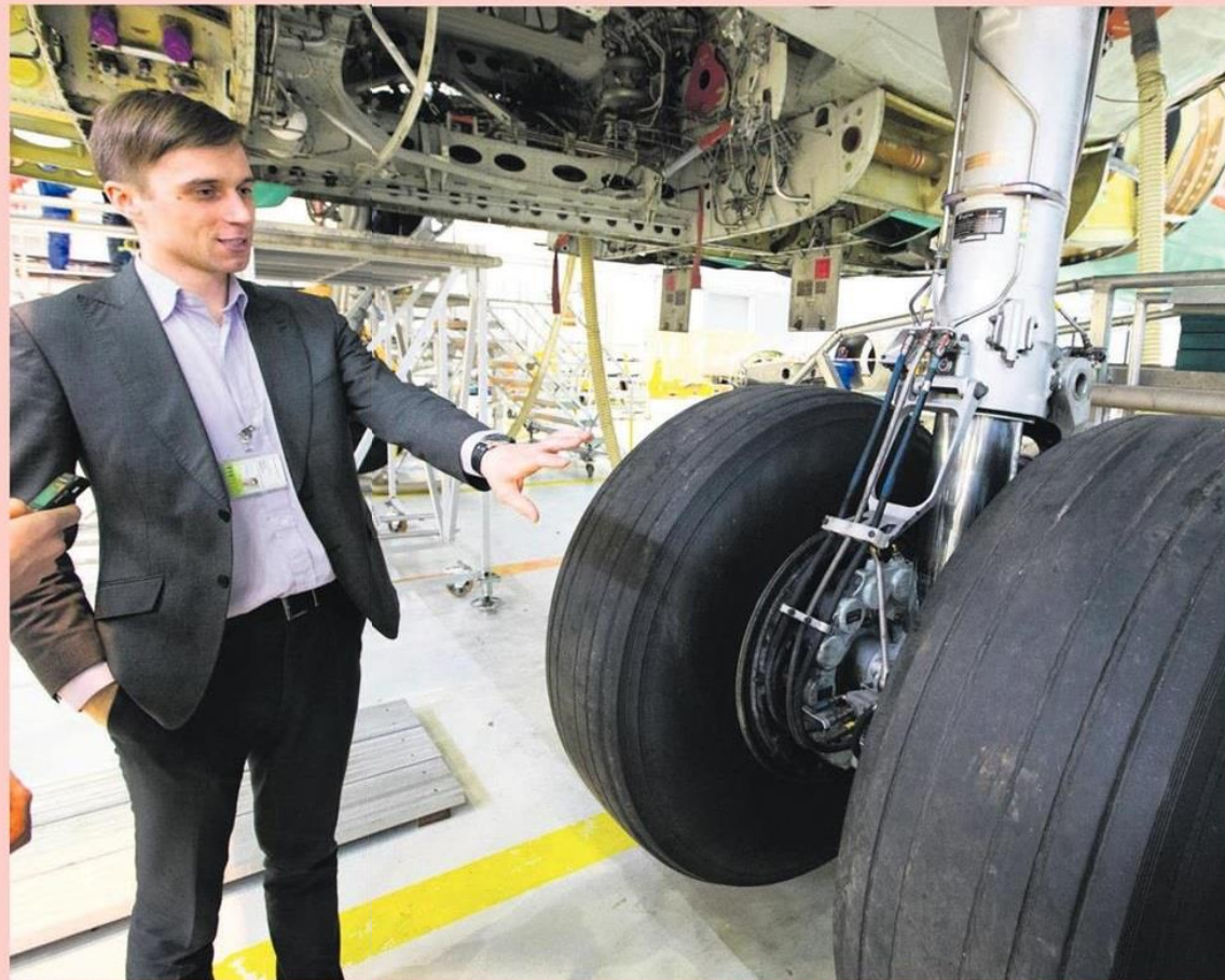
Magnetic MRO juht Risto Mäets selgitab, et lennuki ratalastel on süsinikpidurid, mida kasutatakse ka vormelitel. Ainuüksi ühe ratta piduriketast maksab 35 000 eurot ja peab vastu kuni kaks aastat.
